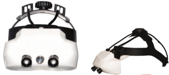
Abb. 1: Mixed Reality Datenbrille mit Lupenobjektiven
